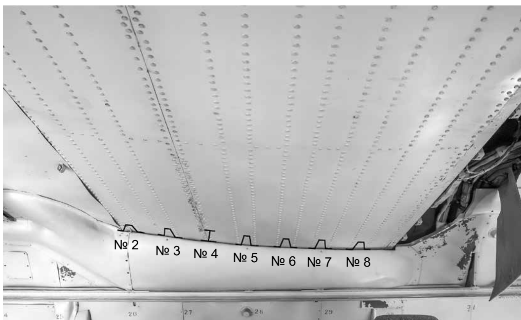
Фото 1. Нижние панели обшивки центроплана крыла Ан-12 СССР-11339, полностью идентичного самолету Ан-10. Видны ряды заклепочных швов, крепящих стрингеры к панелям обшивки. Около бортов фюзеляжа схематично показаны профили стрингеров, приклепанных к панелям обшивки с внутренней стороны. Двухавровый стрингер № 4 соединяет переднюю и заднюю панели. Заклепочные ряды стрингера № 1 скрыты декоративной обшивкой салона. Фото из личного архива автора
